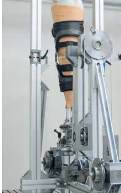
Abb. 3 Funktionsprüfstand für Knieahmenorthesen.
